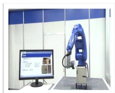
電子機器に使用する部品の検査に用いるロボット(参考画像)
